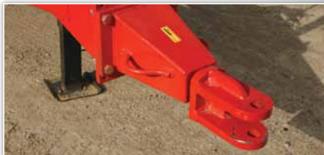
Bloc d'attache ajustable sur la hauteur Doté d'une main à virole de conception unique pour l'assemblage le plus robuste de l'industrie.
