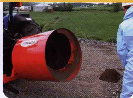
Vis sans fin servant au mélange et vidage
