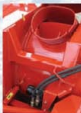
ROTATION DU TAMBOUR PAR MOTEUR ORBITAL POUR TOUS LES MODÈLES TRC
